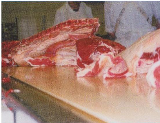
Wir bieten unter anderem ein speziell gewebeverstärktes Band an. Es kann große Lasten, bei gleichzeitig kleinem Trommeldurchmesser befördern. Dieser Gurt hat eine einzelne Gewebelage auf der Laufseite, die zusätzlich mit TPE imprägniert ist. Auf der Tragseite des Transportbandes verbleiben 1,6 - 8 mm TPE.
