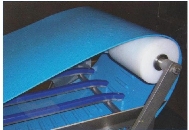
FHB-3: Umlenktrommel u. Gleitschienen
